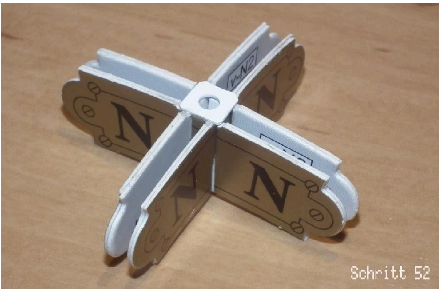
Probeweiser Zusammenbau des noerdlichen Lagers zu einem Doppelkreuz mit Anpassung der Lagerscheibe.
