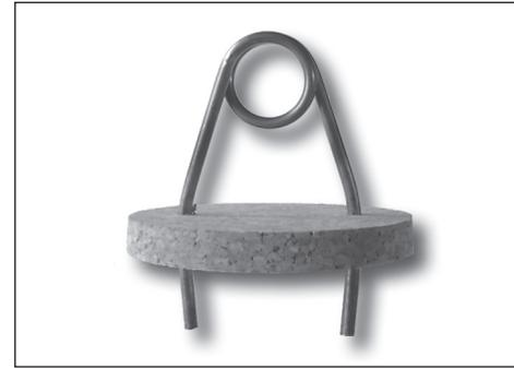
**Schritt 3:** Jetzt muss das Kupferrohr an den beiden Enden auf einer Länge von ca. 20 mm zu einer 90°-Rundung (Viertelkreis) gebogen werden, und zwar in entgegengesetzte Richtungen (s. Abbildung unten). Auf diese Weise erhält die Korkscheibe einen zur Drehung führenden horizontalen Schub, wenn das Wasser aus den Enden des Rohres ausgestoßen wird.
